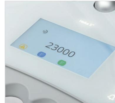
La vue d'affichage avec vue situationnelle, représentée ici avec l'instrument à basse vitesse - micromoteur.
